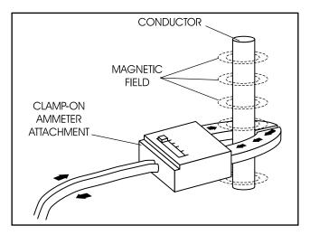
Figure 2. Clamp-On Ammeter
